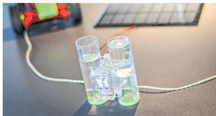
Solarenergie verwandelt in einer Brennstoffzelle Wasser in Wasserstoff und Sauerstoff.
